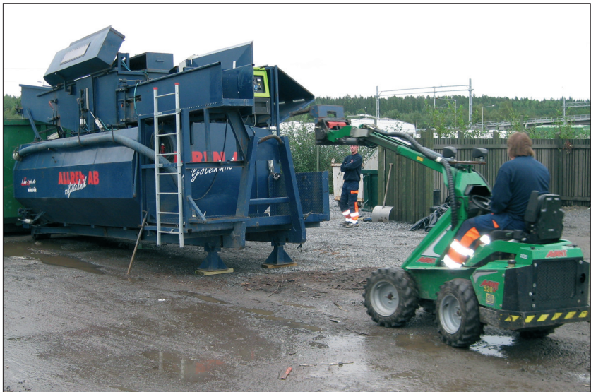
Efter insamlandet töms kärlen maskinellt. Här lastas de i latrinmaskinen.
