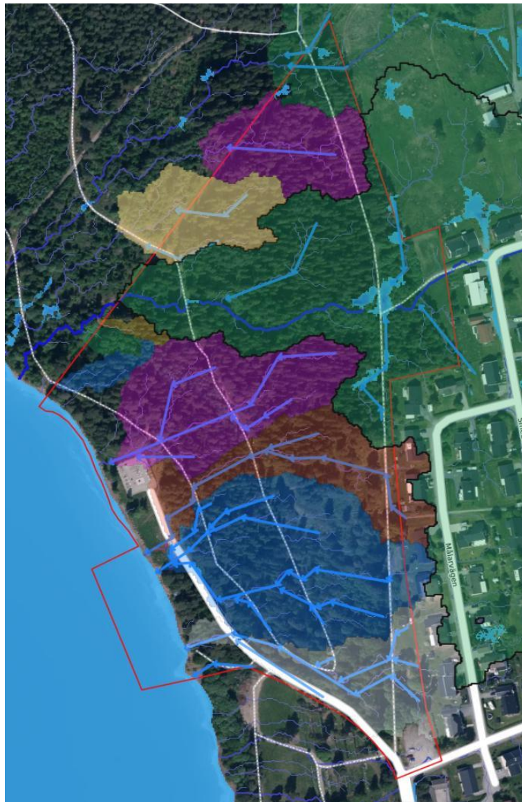
Figur 11 Avrinningsanalys i Scalgo. I figuren redovisas detaljplanegränsen (röd linje), generellt avrinningsmönster (tunna blå linjer) och dämningssområden/lågpunkter (ljusblå skrafferingar). Källa: Dagvattenutredning, Arctan, 2026-04-02.
